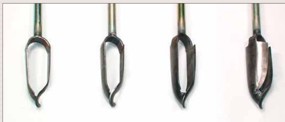
Буры Эдельмана: для глин, для комбинированных почв, для песчаных почв, для крупнозернистых песков
